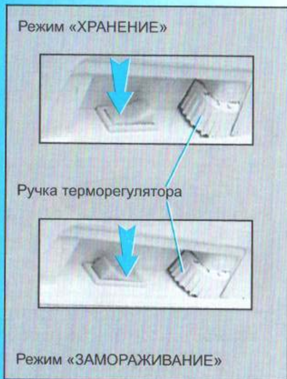
Рисунок 5 - Схема расположения переключателя режимов
