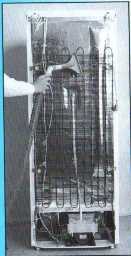
Рисунок 2 - Уборка холодильника (вид сзади)
